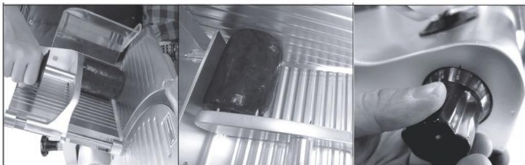
HINWEIS: Stehen Sie stabil, längs zum Gerät. Legen Sie die rechte Hand auf den Schieber und danach die linke Hand neben den Schneidegutabstreifer. Der Körper muss senkrecht zur Arbeitsfläche des Allesschneiders sein.
