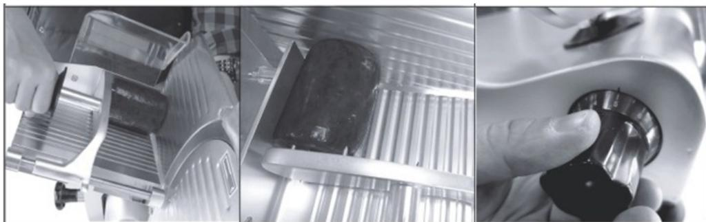
REMARQUE: l'utilisateur doit se tenir debout, face à la machine, sa main droite tenant fermement le presse-produit, la main gauche reposant à côté du déflecteur. Il se positionne perpendiculairement au plan de travail de la trancheuse.
