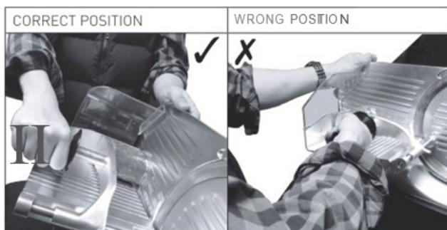
ATTENTION: veiller à ce qu'aucune partie du corps de l'utilisateur n'entre en contact avec la lame en rotation. Pour des raisons de sécurité, ne jamais utiliser cet appareil avec des vêtements amples ou de longs cheveux détachés.
