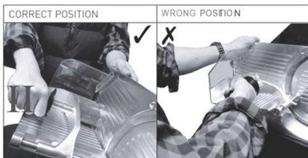
ACHTUNG: Nehmen Sie keine Positionen ein, bei denen Körperteile mit dem Messer in Kontakt kommen. Aus Sicherheitsgründen, tragen Sie keine weite Kleidung oder offene lange Haare, wenn Sie dieses Gerät betreiben.
